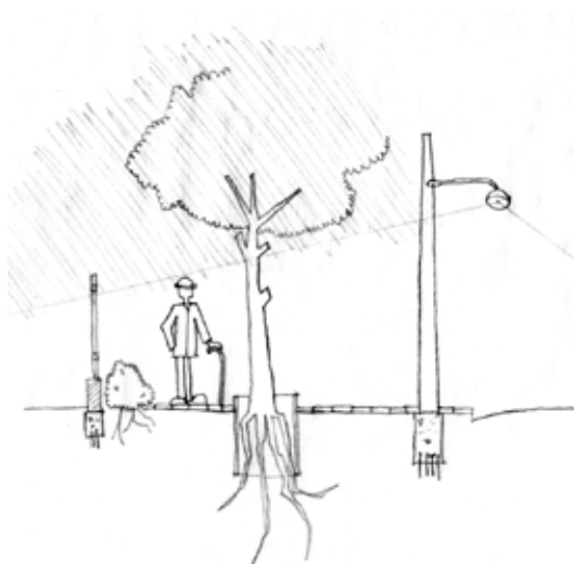
Figura 04: O controle do paisagismo através do tutoramento das raízes e da poda correta evita interferências com a iluminação e melhor conservação das calçadas.
